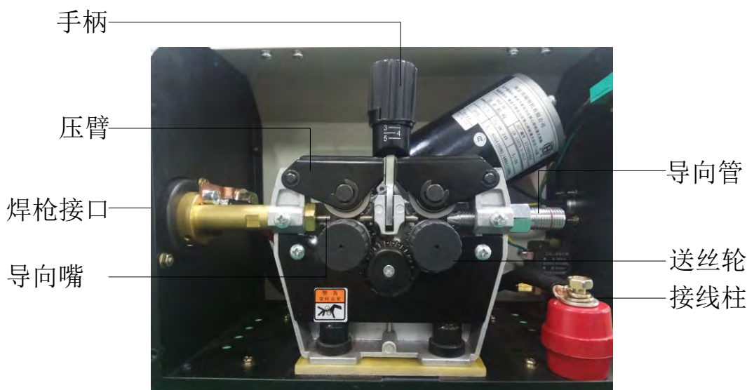
图 6 焊丝安装示意图
